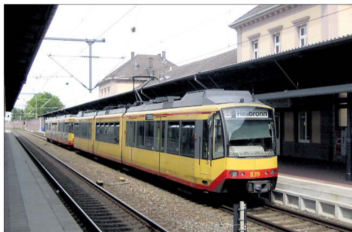
TOGTRIKK: Her er en togtrikk på stasjonen i Baden-Baden. Den går på jernbanespor mellom Karlsruhe og byene rundt, men på trikkespor inne i Karlsruhe. Det har lenge vært jobbet for å få en slik togtrikk mellom Hamar og Elverum.
